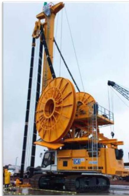
La Hidrofresa que se muestra en la fotografía precedente constituye el elemento perforador que fue equipado especialmente con controles, motores, bombas y mangueras hidráulicas con la finalidad de lograr una profundidad de 125 metros, medida máxima a nivel mundial, la cual fue alcanzada gracias a la alta precisión de sus sistemas.
