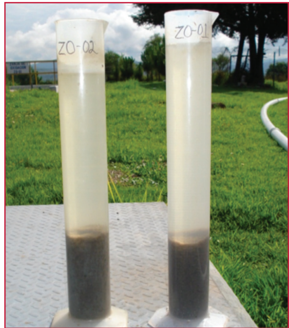
Ilustración 1.45 Prueba de IVL
