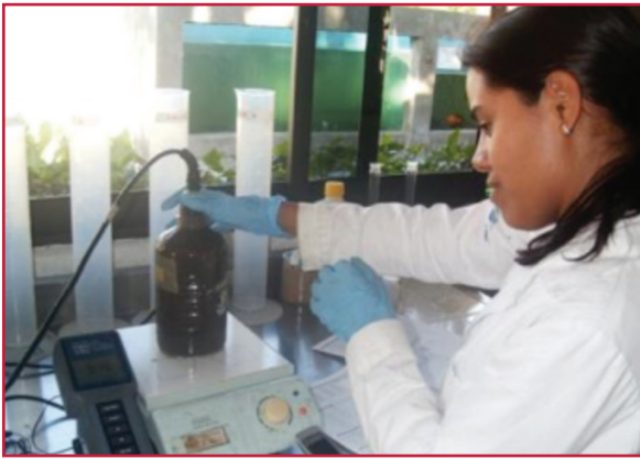
Ilustración 1.32 Prueba de consumo de oxígeno
