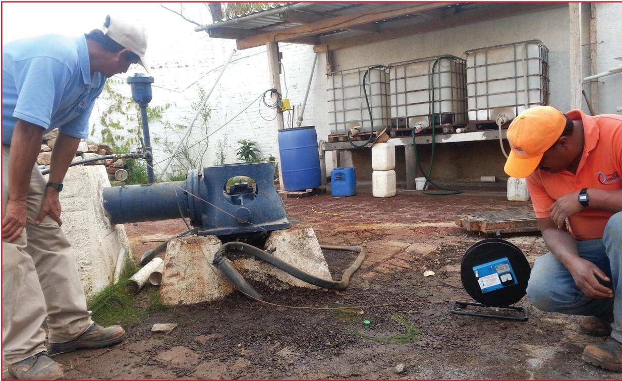
Ilustración 6.12 Medición del nivel dinámico en cárcamos de rebombeo
